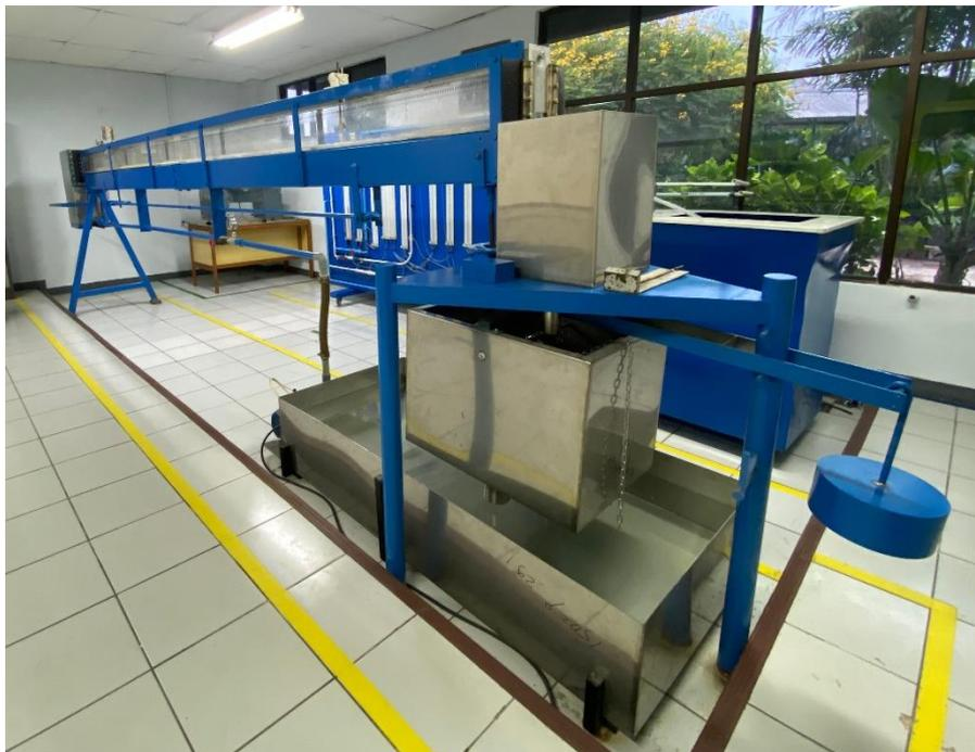
**Gambar D.2 Sistem Saluran Terbuka**
